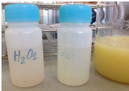
ภาพที่ ข - 1 การตรวจสอบประสิทธิภาพ ในการลวก ของข้าวโพดฝักอ่อน
